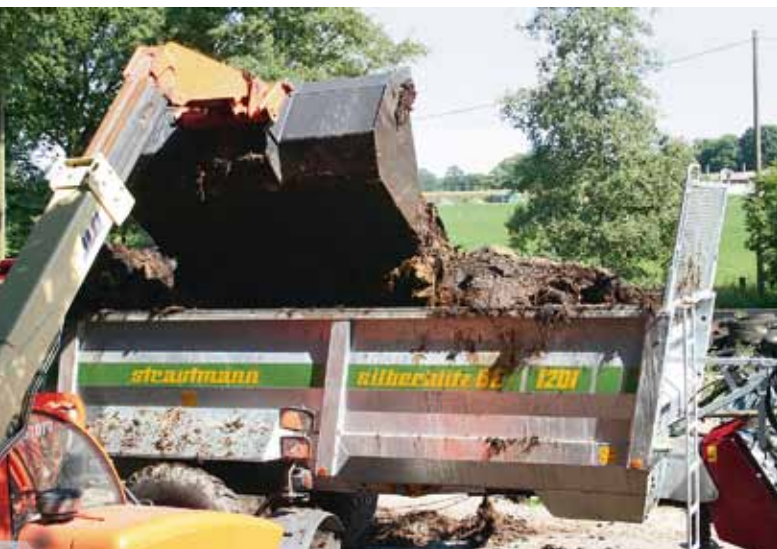
Die Überladehöhe liegt bei der großen Bereifung bei gut 2,50 m. Die Reibleiste aus Kunststoff könnte etwas stärker sein.
