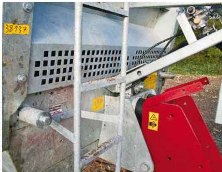
Die Deichsel ist über PU-Blöcke gedämpft. Die Kratzboden-spannung erfolgt automatisch.
