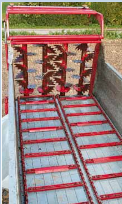
Der Boden besteht aus Kunststoff, über den Ketten und Material gut gleiten können. Die Ketten sind stabil, die Profile über den Leisten sollen das Aufschwimmen der Kette verhindern.
