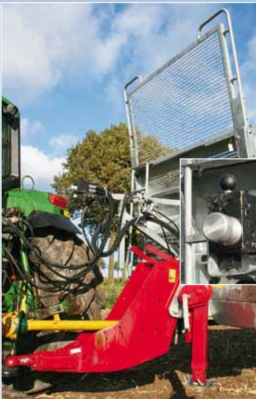
Die Garderobe ist zweckmäßig. Schöner wäre ein Aufstieg an der linken Seite. Das Schutzgitter hat inzwischen einen Handlauf – prima. Kratzbodenvorschub und Reversierung können von der Kabine aus erreicht werden.
