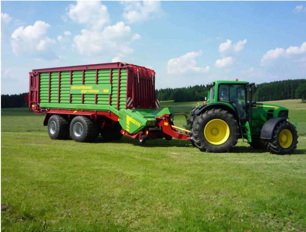
Einsatzbild 1: An allen Giga-Vitesse CFS sind ab Herbst 2010 elektronisch hydraulische Zwangslenkungen erhältlich.
