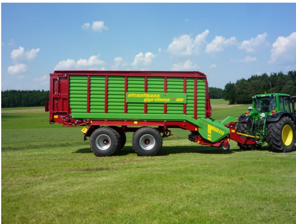
Einsatzbild 2: Mit dem SES folgt der Ladewagen der Schlepperspur.
