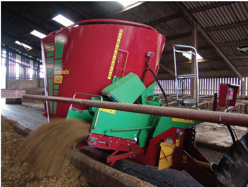
Das Strautmann C-Band erlaubt Ausbringhöhen von 1,40m
