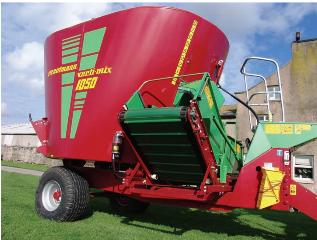
Das C-Band von Strautmann kann als normales Querförderband, als verschiebbares Querförderband, sowie als „Höhenförderer“ eingesetzt werden.
